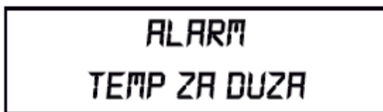
Rys. 8 Komunikat zbyt wysokiej temperatury w kotle
