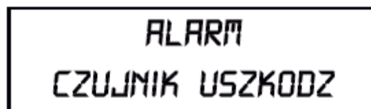
Rys. 9 Komunikat uszkodzenia czujnika
